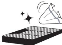
■ヒーターユニットは分解せず、自転車の空気入れ等を利用してヒーターやファンのまわりについたホコリを吹き飛ばして下さい。
