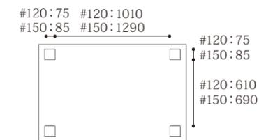
天板: タモ板目突板 / 天板縁材: タモ材 / 塗装: TXLウレタン塗装 (SG色)
